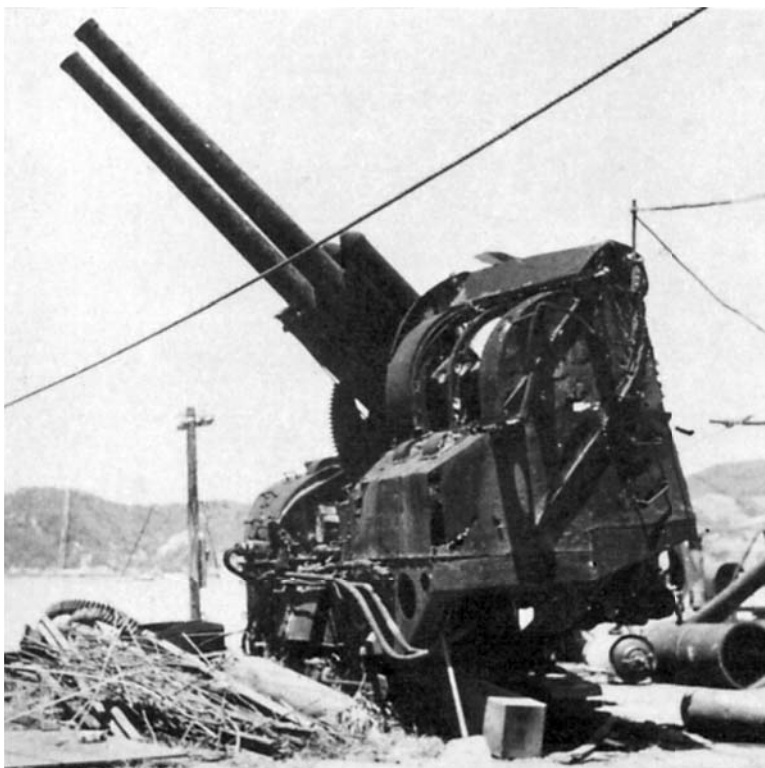
Спаренная 12,7-см артустановка эсминца «Наси», снятая с корабля после его подъёма на поверхность
