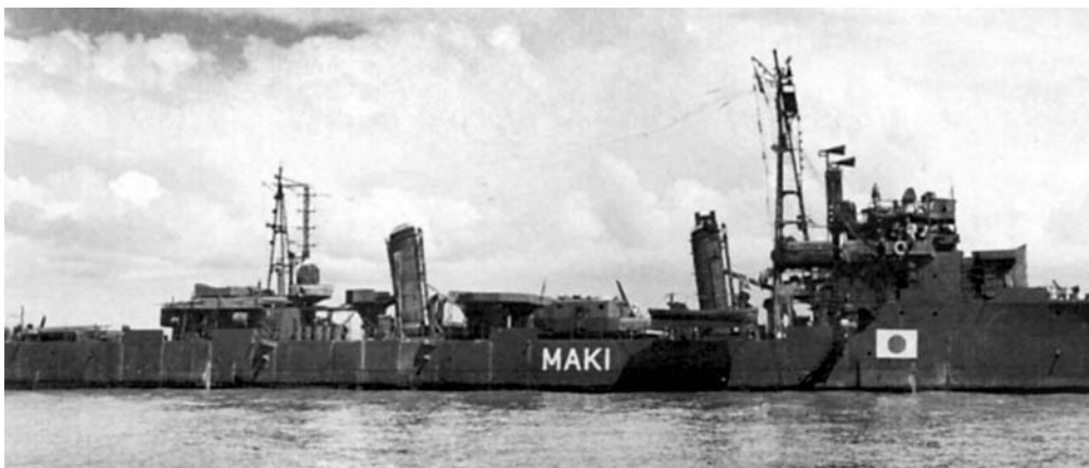
Эсминец «Маки» в гавани Манилы, октябрь 1945 г. Корабль уже лишён артиллерийского вооружения, но ещё несёт торпедный аппарат
