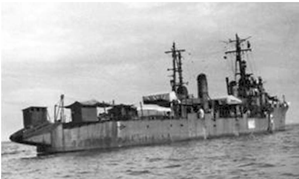
«Маки» в Маниле после войны. Несмотря на плохое качество снимка, можно разглядеть тенты, натянутые над палубой для защиты размещённых на ней репатриантов от солнца и дождя, а также дополнительные галюны, устроенные в кормовой части. Хорошо видна сохранившаяся раampa для пуска человеко-торпед «Кайтэн»
