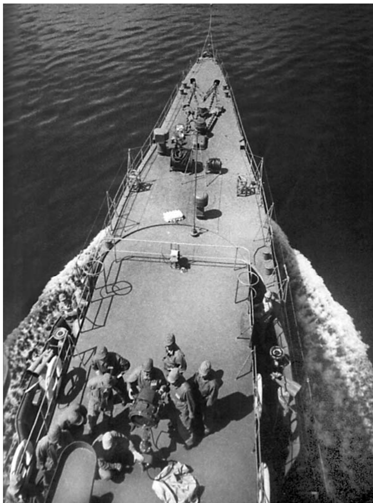
Вид на верхний мостик учебного корабля «Вакаба». Обратите внимание на прожектор и минимальное количество оборудования на мостике
