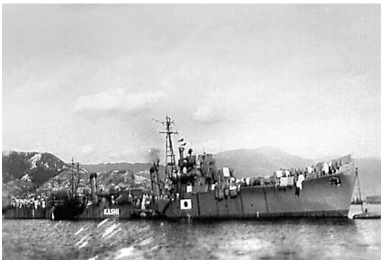
Эсминец «Каси» после войны. С корабля снято всё артиллерийское вооружение, но не демонтирован торпедный аппарат
