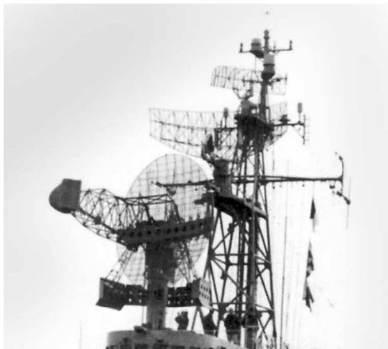
Радары на «Вакаба», 1962 г. Снизу вверх: SPS-8B, SPS-12, SPS-5B
