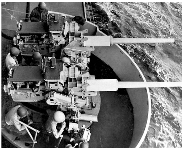
76,2-мм/50-калиберная артиллерийская установка Mk33 на авианосце «Мидуэй» (CV 41 «Midway»)
