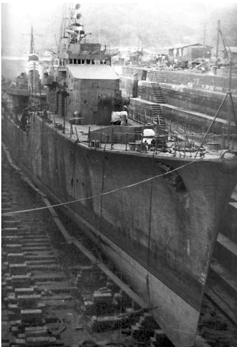
Эсминец «Суги» в доке. Хорошо видно дополнительную закрытую надстройку, возведённую на месте расположения 3-ствольного 25-мм зенитного автомата №1. Обратите внимание, что корабль сохранил военную маркировку на кормовой дымовой трубе
